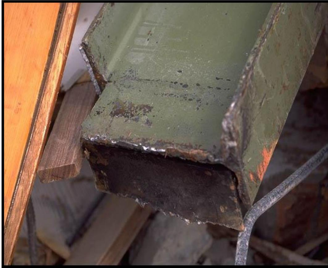
**Rupture de soudure**
